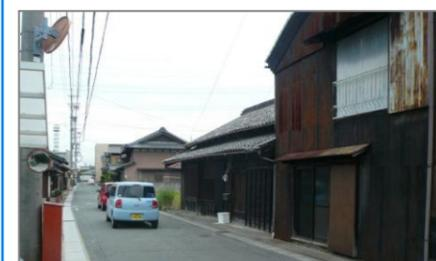
カラー舗装、スリット側溝整備により、車両走行速度の抑制と歩行スペースの明確化を図ります。
